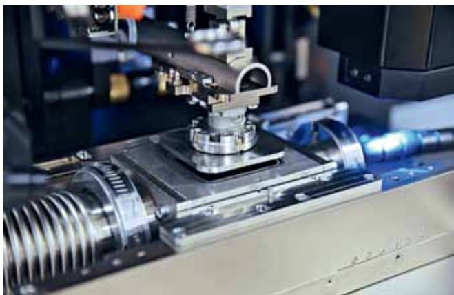
Модульная вакуумная камера легко интегрируется с системой субмикронного монтажа FINEPLACER sigma The Vacuum Chamber Module easily integrates into a FINEPLACER sigma sub-micron bonder
